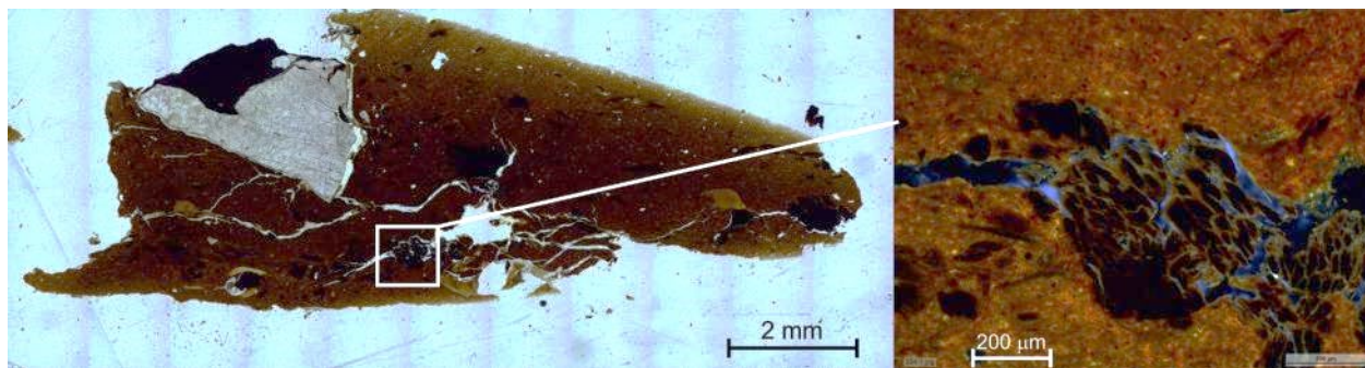
Микрофотография шлифа экспериментального эталона керамики с примесью асбеста, обожженного при 850 °С. Выполнена в ресурсном центре СПбГУ «Геомодель». Эксперимент проводился в Лаборатории реставрации МАЭ РАН
