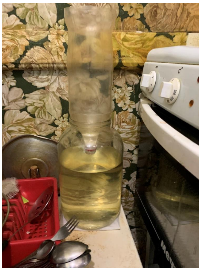
Рисунок 26. Самодельный фильтр для очистки воды. С. Андрюшкино, 2021 г.
