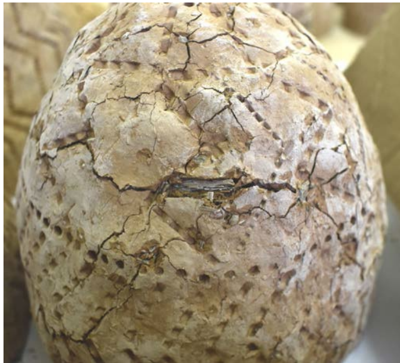
Рис. 1. Экспериментальный сосуд с примесью асбеста после обжига 800 °С. Фото Д.В. Герасимова
