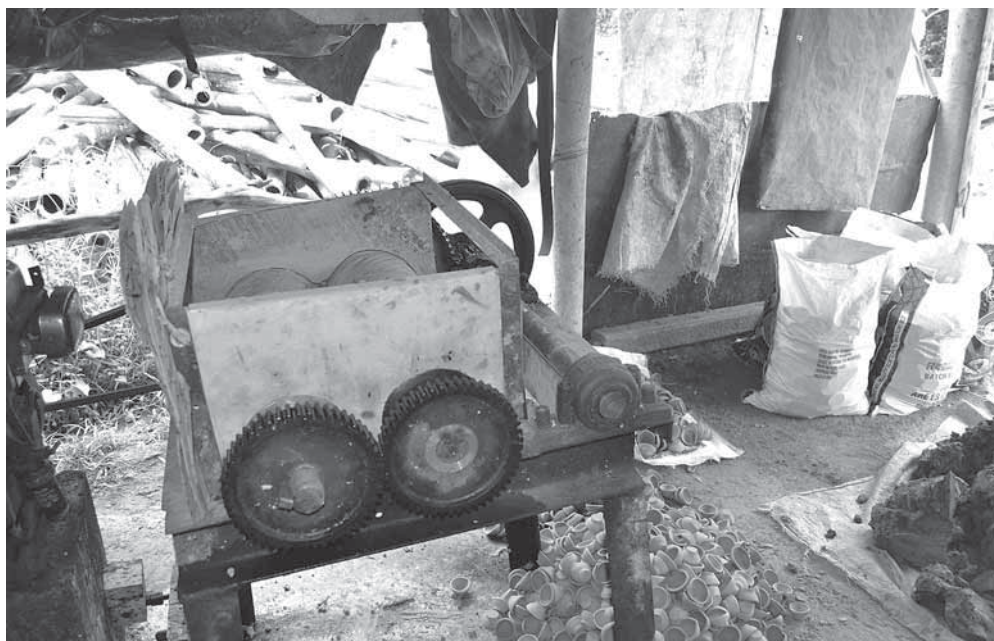
Рис. 2. Станок для разминания глины. Фото И.В. Калининой
